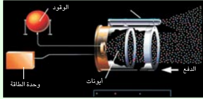
● شكل (٣) نظام دفع كهربائي (xenon).
